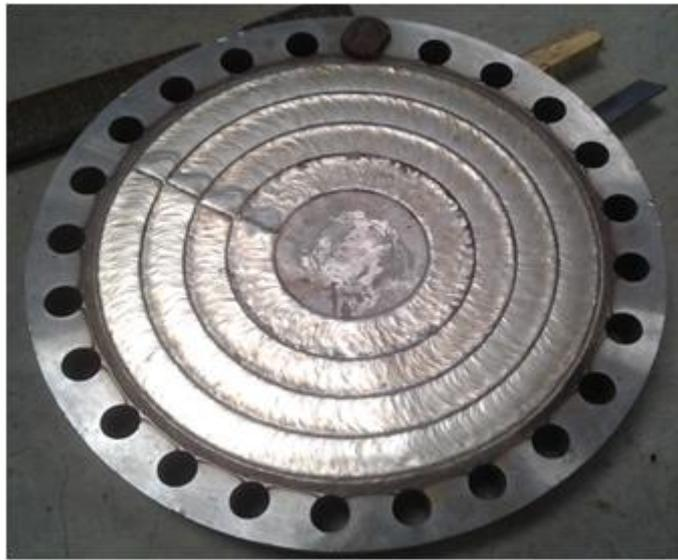
图 1: 堆焊基体材料、层材料
